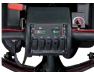
Panel de control sencillo con interruptor e indicador de nivel de carga de batería. En la versión HD con indicador de presión
