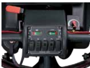
Panel de control intuitivo, controles fáciles de usar con pantalla visual de la presión de cepillos
